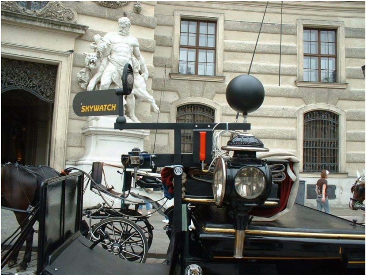
Abb. 5: Klimamessstation auf der Kutsche.
